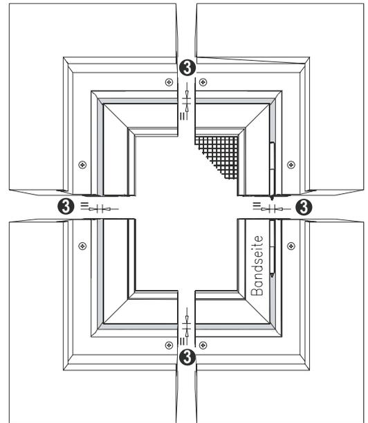
**Achtung:** Die Drehbandstifte müssen vor der Montage mit NEHER-Beschlagspray eingefettet werden.
