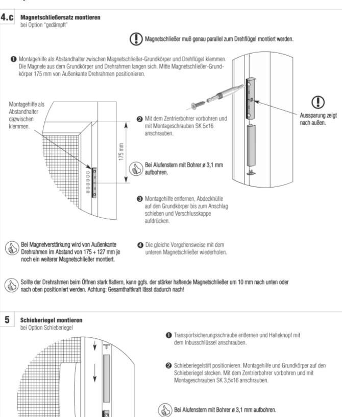
Montagehilfe entfernen, Abdeckhülle auf den Grundkörper bis zum Anschlag schieben und Verschlusskappe aufdrücken.
