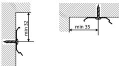
Position der Träger anzeichnen und die Träger an Wand oder Decke befestigen
