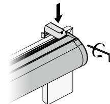
**Klemmträger mit Sechskantschlüssel am Fensterflügel befestigen.**
