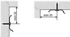
Position der Träger anzeichnen und die Träger an Wand oder Decke befestigen
